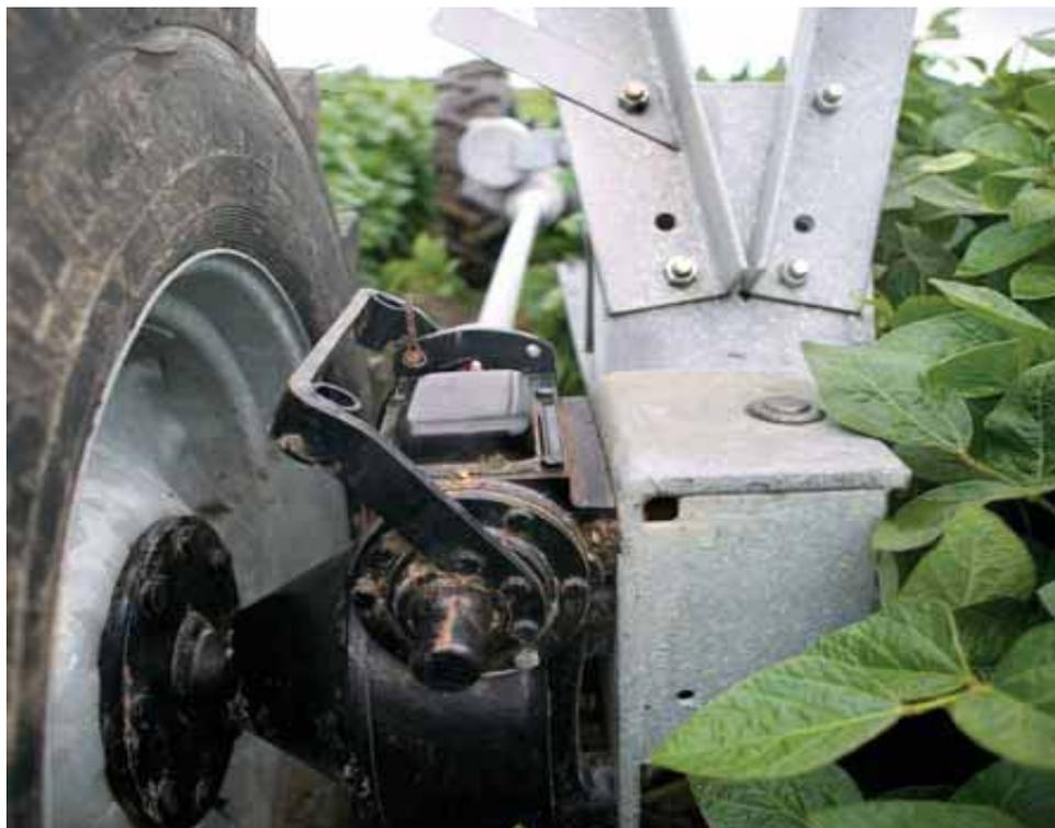
**EL EJE Y LA LLANTA DEL PIVOTE CENTRAL, QUE SE MUEVE AUTOMATICAMENTE POR SEÑALES ELÉCTRICAS ENVIADAS POR LA CAJA DE CONTROL.**
