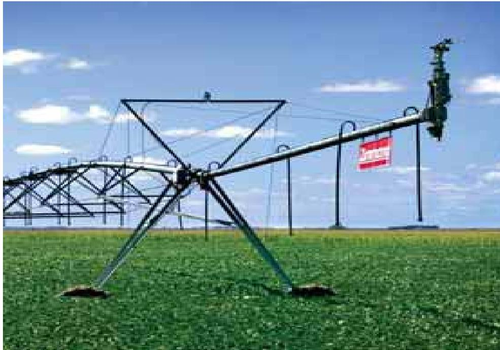
**PIVOTE CENTRAL DE SIETE SPANS O TRAMOS, SE UTILIZA PARA REGAR EL CULTIVO DEL ALGODÓN. EN LA FOTOGRAFIA SE PUEDE APRECIAR EL CAÑON FINAL, EL CUAL TIENE UN ALCANCE DE 12 METROS.**
