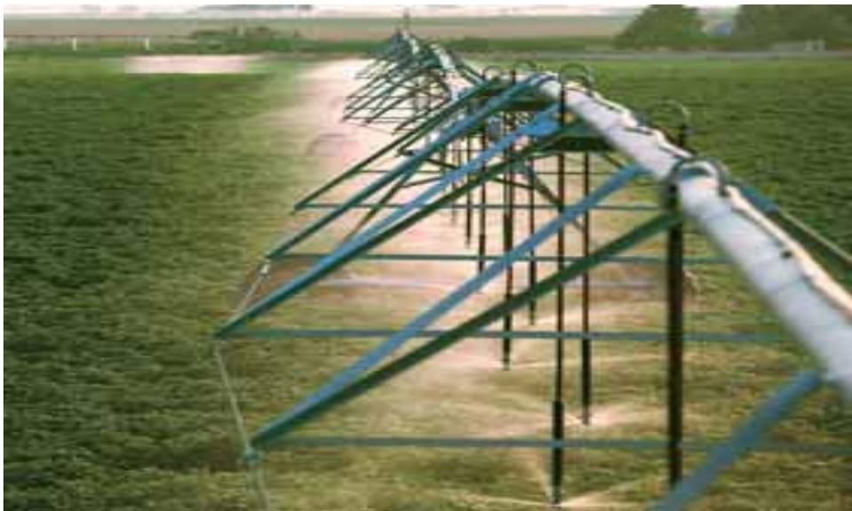
**EL PIVOTE EN PLENO RIEGO. SE APRECIA LOS TENSORES, ASI COMO LOS COLGANTES CON SUS ASPERSORES CON UNA DISTANCIA DE DOS METROS ENTRE UNO Y OTRO.**
