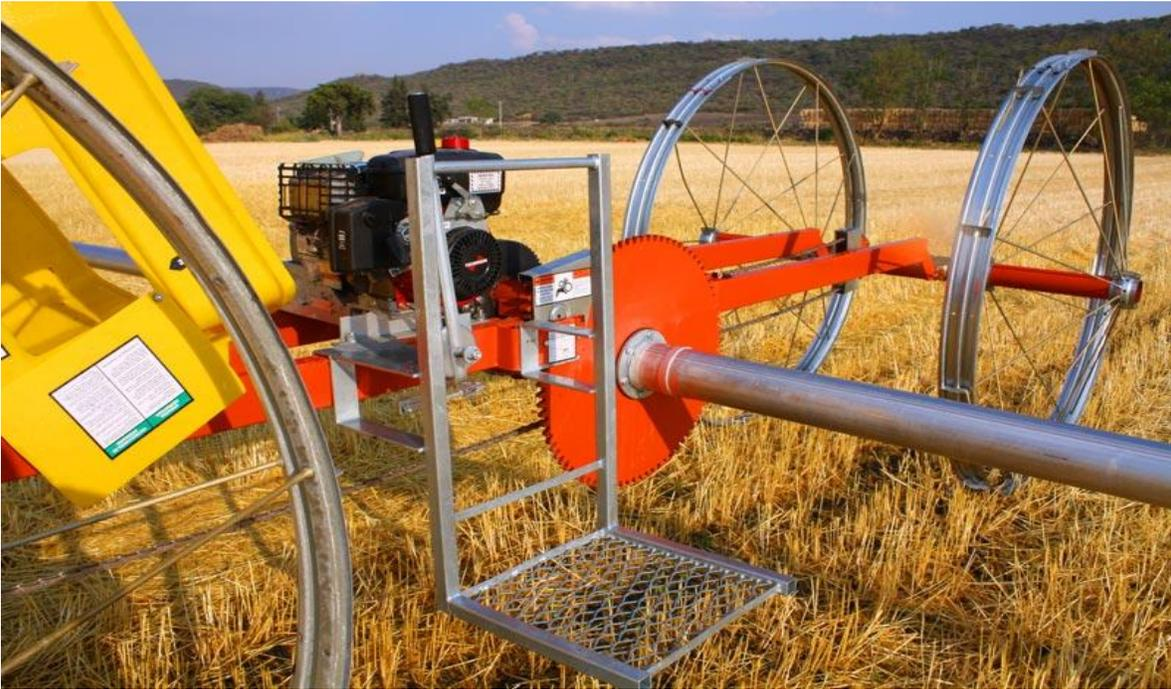
Figura 2.1 unidad motorizada que se usa para mover la tubería del Powerroll.
