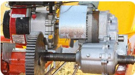
Fig. 2.3 vista de la transmisión hidrostática del sistema Poweroll
