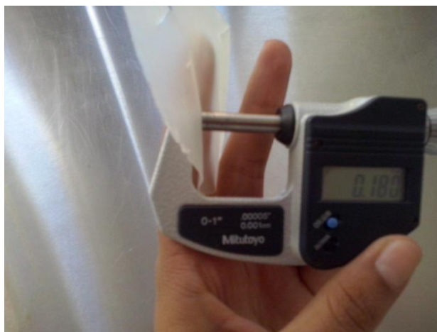
Figura 15 Medición del grosor con un micrómetro Mitutoyo Corporation
