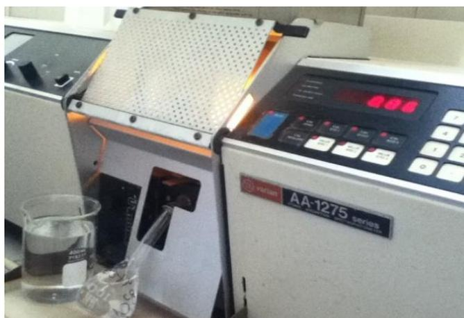
**Figura 10. Imagen del equipo el cual se determinó (Potasio, fierro, magnesio y calcio).**
