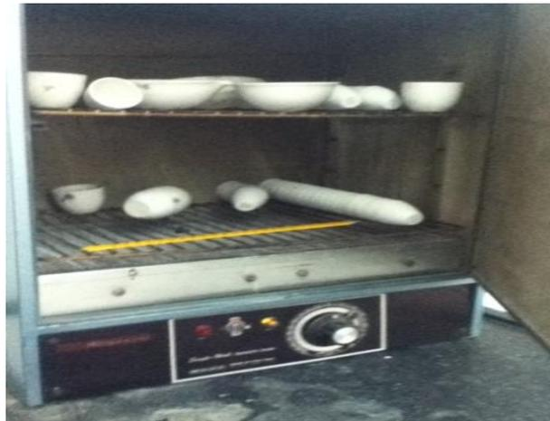
**Figura 5. Imagen de Determinación de materia seca total.**
