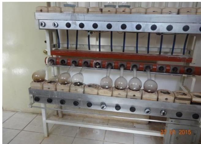
Figura 9. Imagen Determinación de Proteínas.
