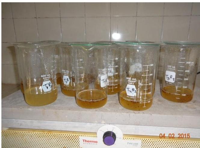
**Figura 8. Imagen Determinación de Fibra Cruda**
