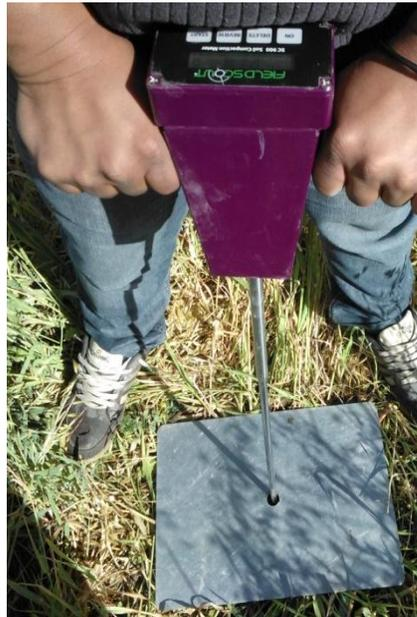
**Figura 5.5.** Resistencia a la penetración
