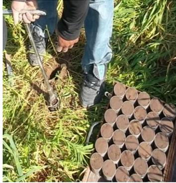
**Figura 5.4.** Muestreo de densidad aparente
