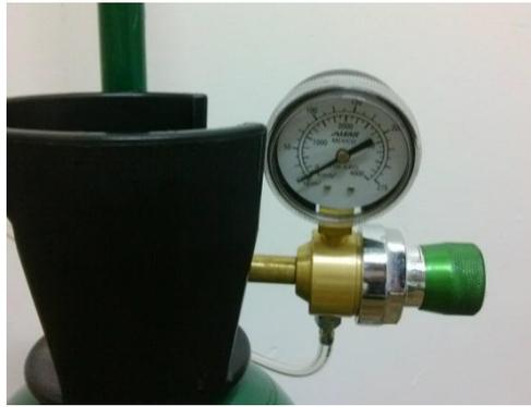
Fig. 5.- Grifería de los cilindros
