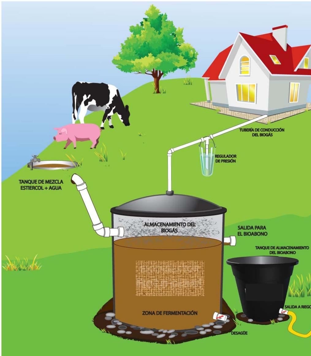
**Figura 12.** Biodigestor anaeróbico para la producción de biogás (<http://www.google.com.mx>).
