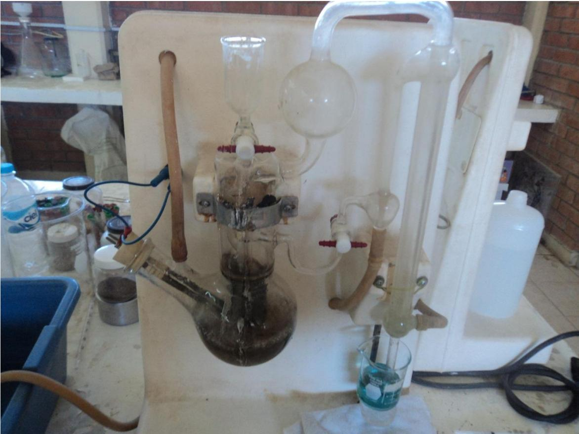
Figura 6.- Destilador para la obtención de proteína.
