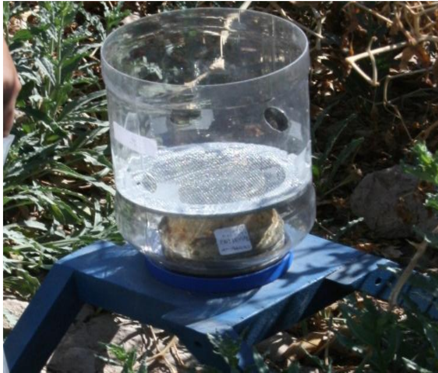
Figura 4. Recipiente inferior del cuerpo de la trampa
