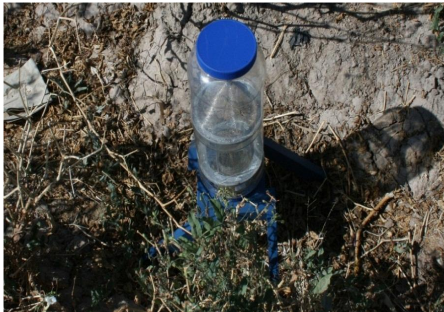
Figura 3. Cuerpo de la trampa WOT anclado a la base
