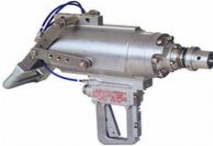
Figura 14.- Pistola neumática para noqueo
