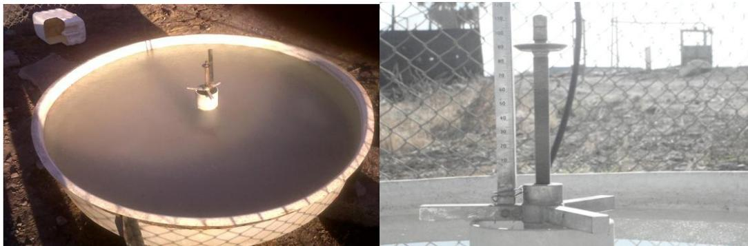
**Figura 1. Tanque Evaporímetro tipo A.**
