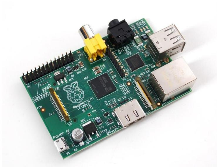
Figura 7. Mini computadora Raspberry Pi
