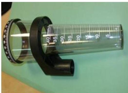
**Figura 16.** Pluviómetro utilizado para medir la precipitación pluvial en las parcelas experimentales.
