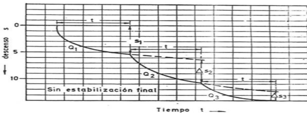
Figura 3 Ensayo de bombeo escalonado con estabilización final Custodio (1976)
