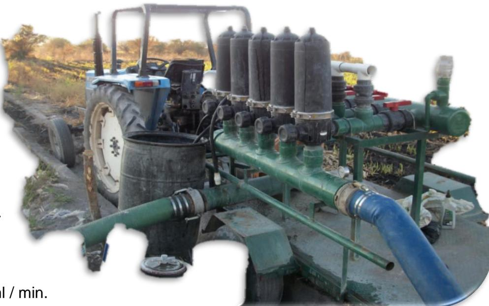
**Figura 17.** Cabezal de riego.
