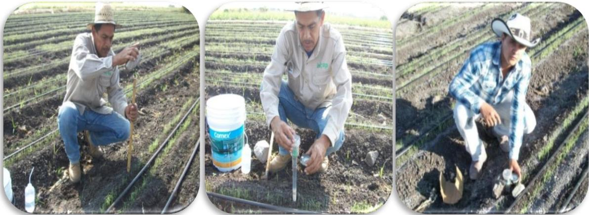
**Figuras 18.** Instalación de los tensiómetros.
