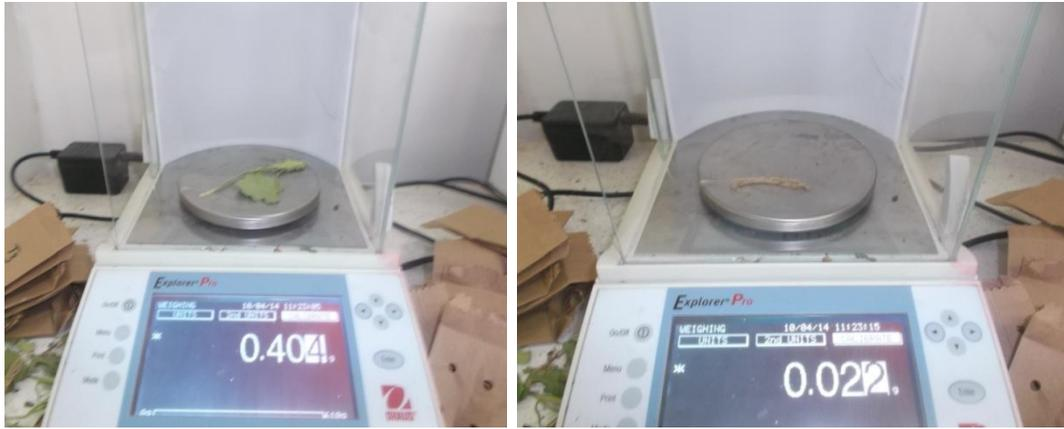
**Figura 7.** Toma de datos de peso fresco foliar peso, fresco de la raíz, peso seco foliar y peso seco de la raíz en el laboratorio.
