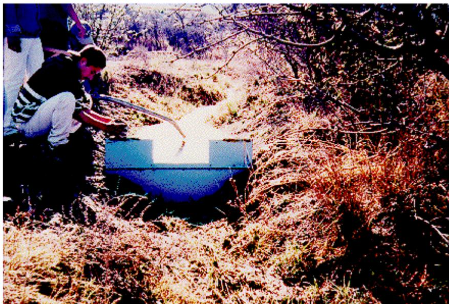
**Figura 19. Vertedor Rectangular de Cresta Aguda con Contracciones Laterales.**
