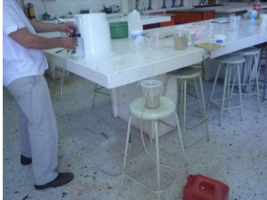
Figura 3.7 Proceso de filtración de agua residual a través de filtro de arena sílica.
