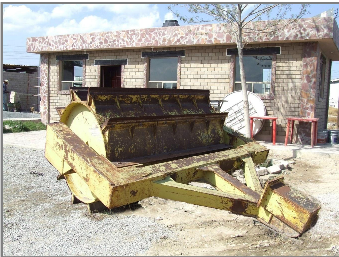
Figura 3. Rodillo con el que se llevo acabo el tratamiento.
