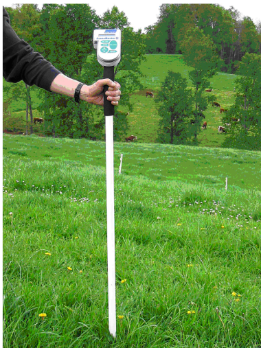
Bastón electrónico medidor de forraje. Tomado del internet. Gob. de Chile. Fundación para Innovación Agraria
