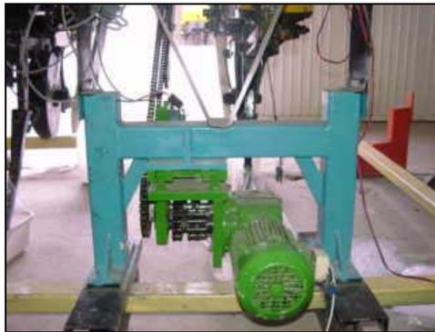
**Fig. 3.8** Motorreductor de .5 HP
