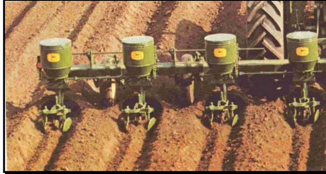
**Fig. 2.14** Sembradora en hileras (surcos)
