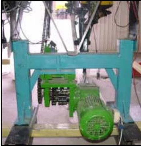
**Fig. 4.3** Banco Modular con un Motóreductor de 0.5 Hp
