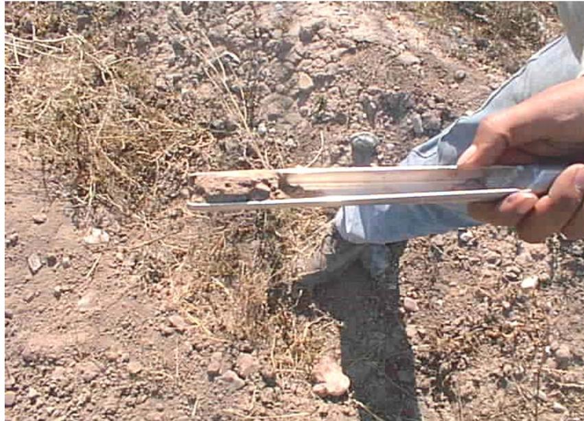
**Fig. 3** Extracción de muestras para determinar humedad
