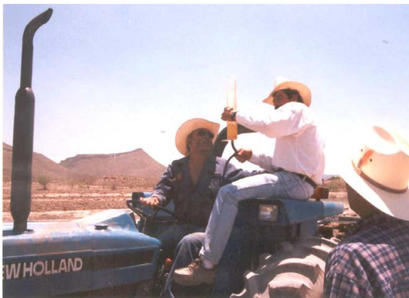
**Fig.11** Medición del consumo de combustible
