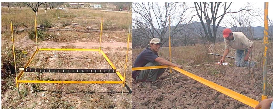
**Fig. 7** Medición del microrrelieve antes y después de la labor (perfilómetro)
