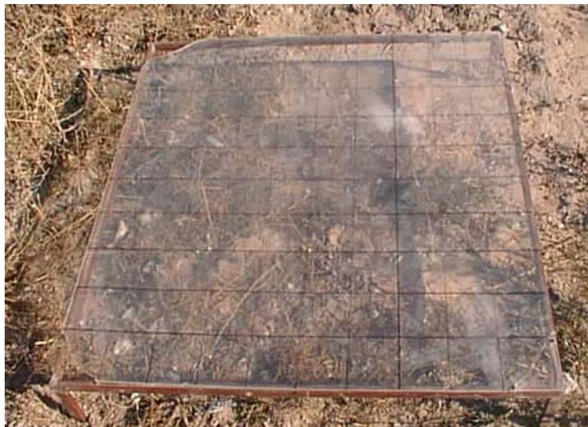
**Fig. 5** Medidor de cobertura**3.3.1.5 Densidad de Cobertura (ton/ha)**
