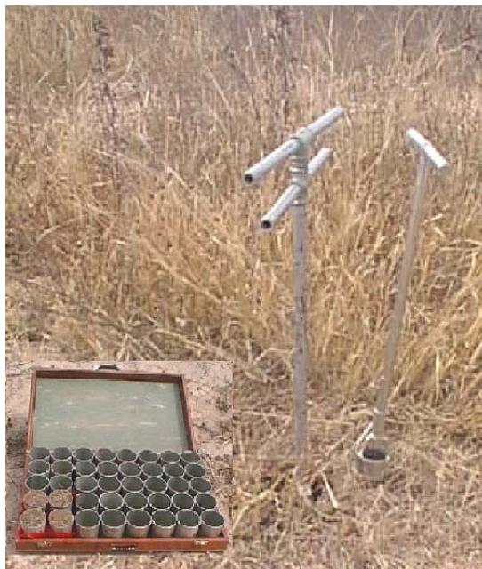
**Fig. 4** Barrena de volumen conocido o extractor de núcleos
