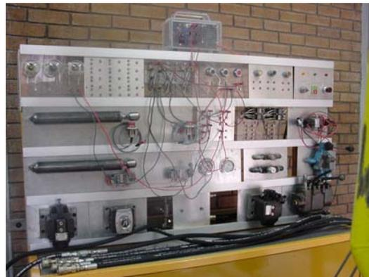
Fig.4.2. Componentes electrohidraulicos en el tablero.
