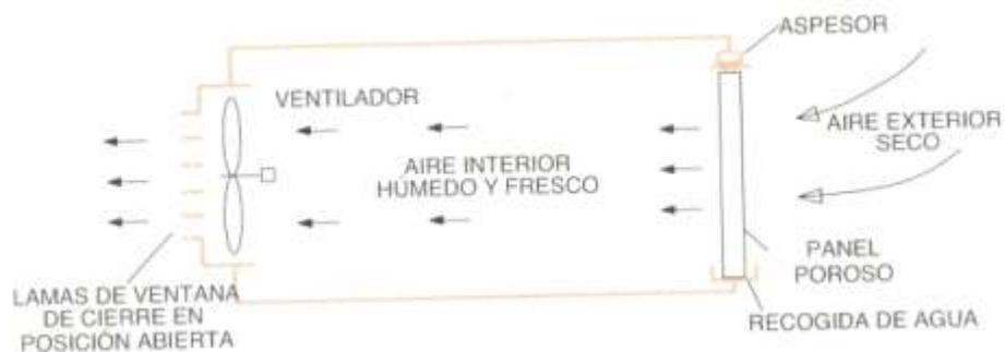
Figura 2.3.- Diagrama que muestra el principio de funcionamiento del sistema cooling
