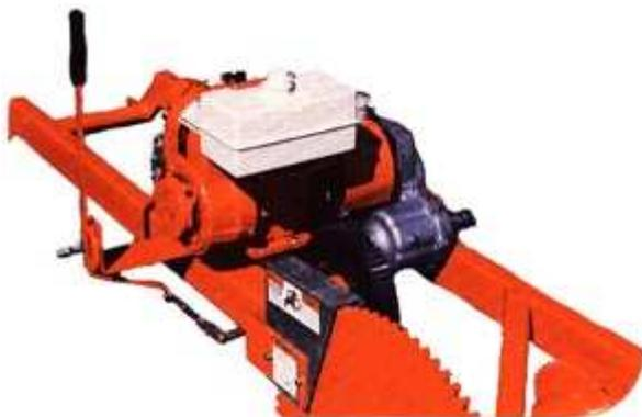
**La unidad motriz Powerroll, de Wade Rain,** con transmisión hidrostática, combinada con un gran chasis de doble raíl, permite salir del fango a plena potencia, baja velocidad y permitir una alta velocidad en suelo seco. El operador tiene un mejor control con el rango de
