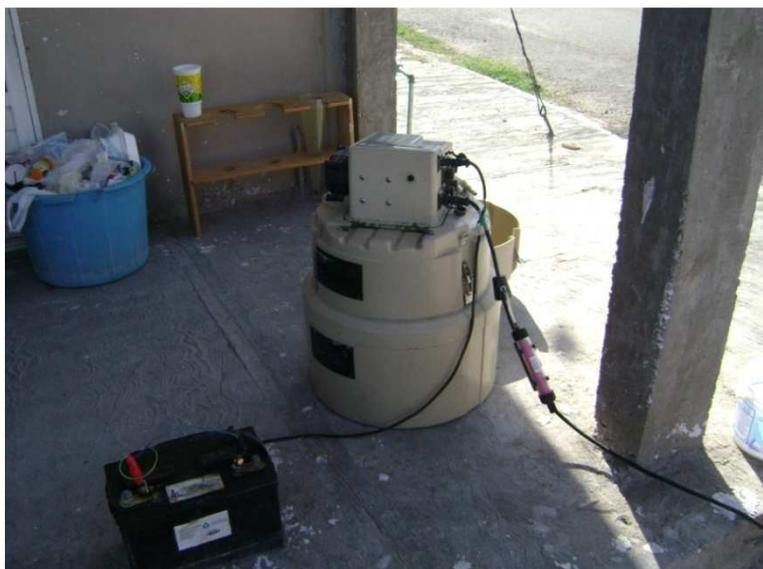
Figura No. 2 Muestreador SIGMA 900 MAX con la fuente de energía.
