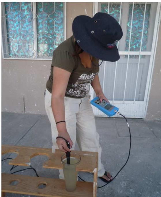
Figura No. 4 Medición del pH.
