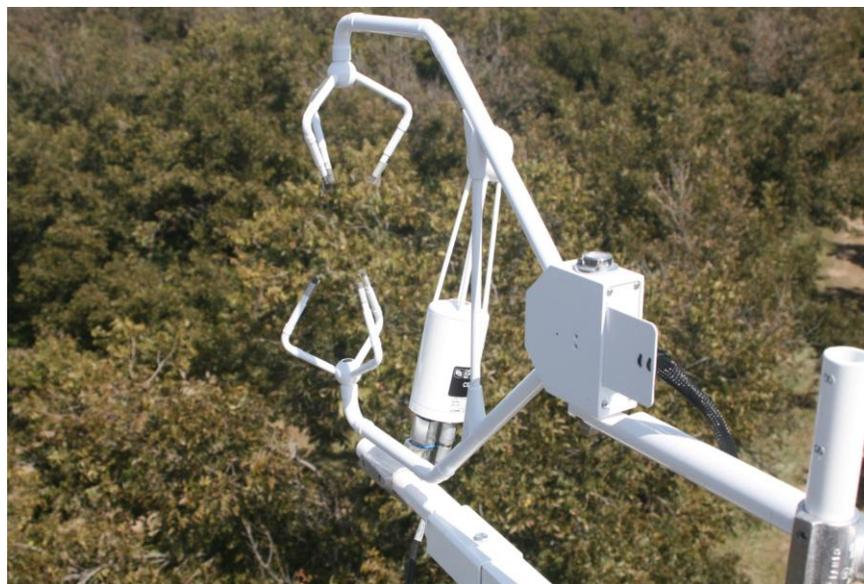
Figura 3.1. Anemómetro sónico tridimensional y analizador de vapor de agua y bióxido de carbono de sendero abierto, sobre el dosel de la huerta de nogal pecanero en Mieleras, Matamoros, Coahuila, México.
