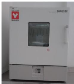
**Figura 5. Estufa con aire forzado (Yamato).**
