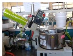
Figura 8. Rotavapor (Yamato, Water Bath BM 400).
