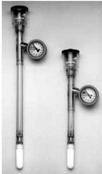
Figura 9: Ejemplo de las partes que conforman un tensiómetro.
