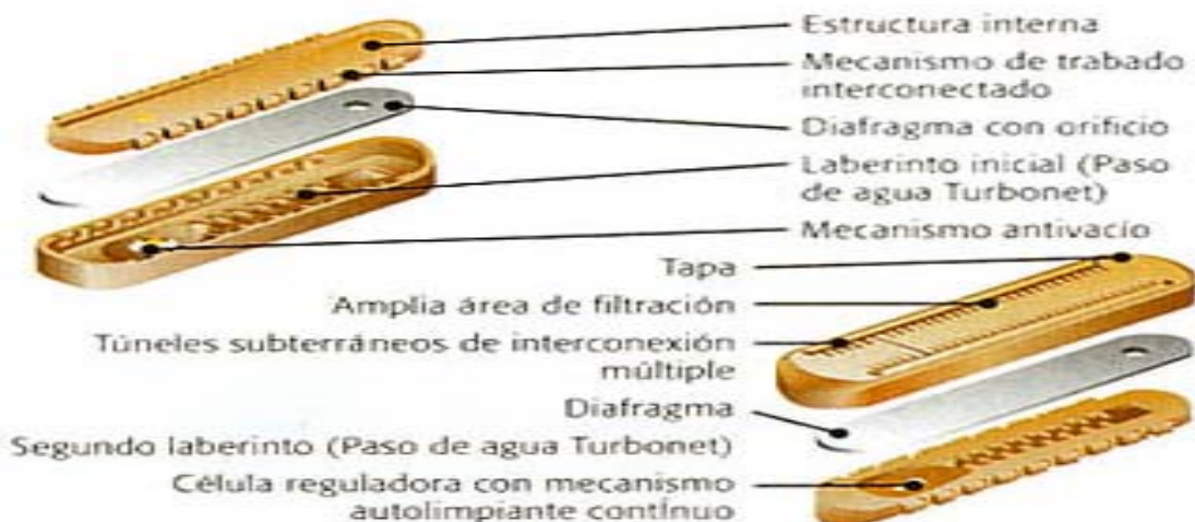
Figura 4: Componentes de la cinta Micro-drip.
