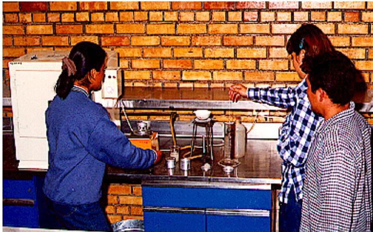
**Figura 5** Determinación de la Densidad Aparente, por el método de la Parafina.
