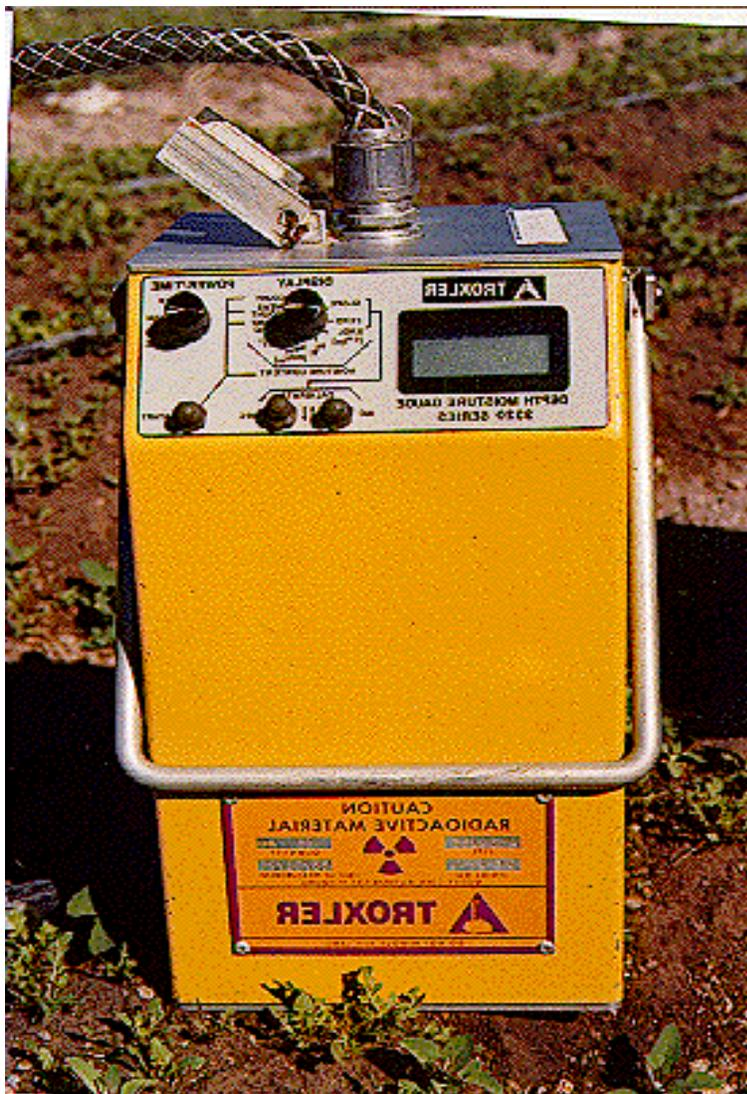
**Figura 8** Dispensador de Neutrones, para la medición de la humedad del suelo.
