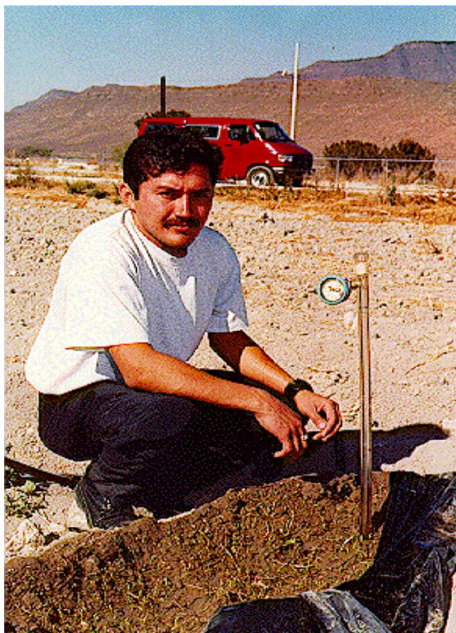
**Figura 7** Medición de la humedad del suelo, por medio del Tensiómetro.
