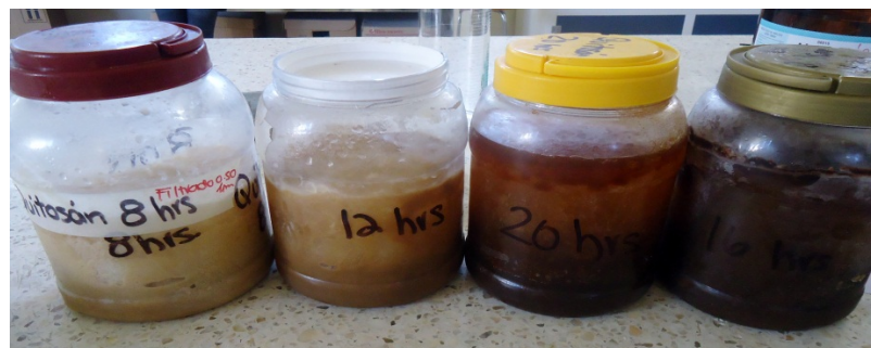
Figura 18. Imagen de los oligosacáridos de quitosán en buffer de ácido acético - acetato de sodio a diferentes pesos moleculares y tiempos de fermentación.
