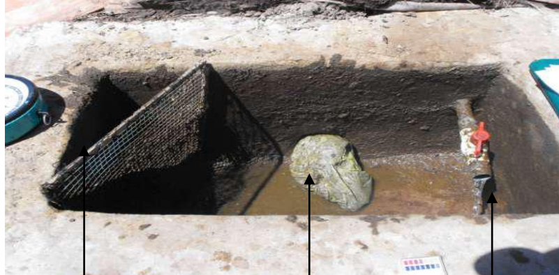
FIGURA 9. ALIMENTACIÓN DE BIODIGESTOR MEZCLA Y CARGA (AFLUENTE)
