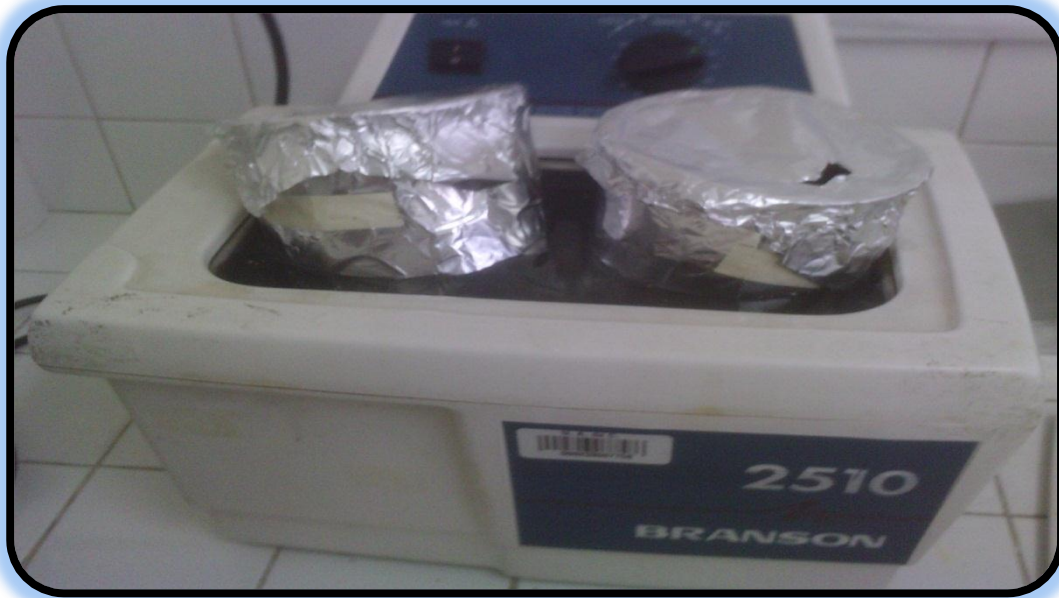
Figura 14. Método de ultrasonido, equipo Sonicador (Bransonic 2510-MTH).
