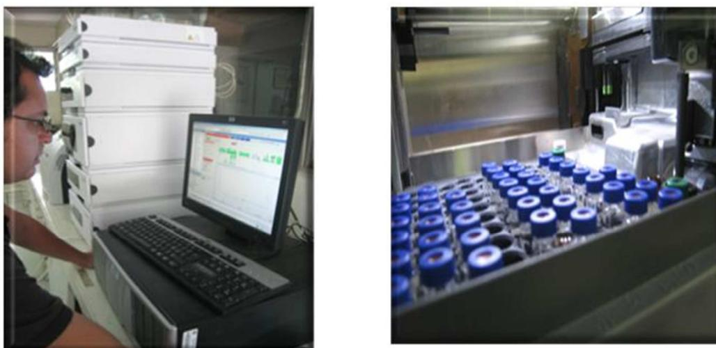
**Figura 20.** Equipo de Cromatografía de líquidos de alta resolución (HPLC).
