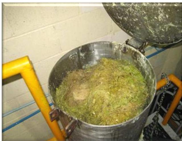
**Figura 15.** Prensa mecánica de 200 L utilizada para obtener el extracto líquido.
