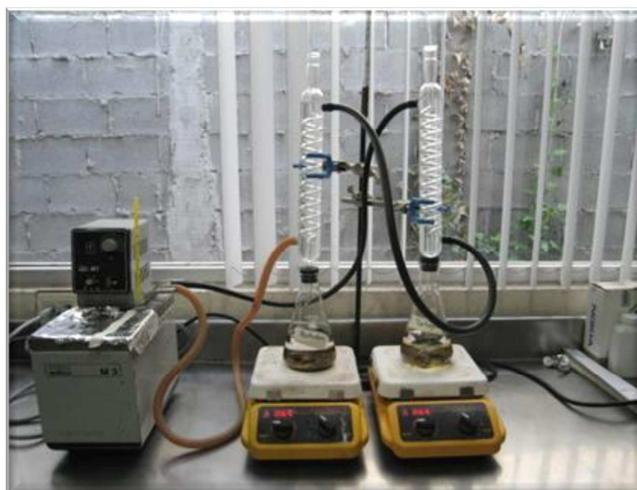
**Figura 16.** Sistema de reflujo utilizado para la obtención de extracto seco de saponinas.
