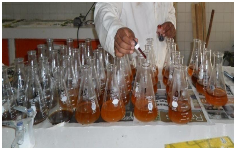
Figura 16. Adición de colorante Ortófenatrolina
