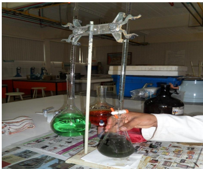
Figura 17. Titulación de las muestras con sulfato ferroso
