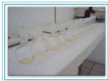
**Figura 9:** Extracción de aceite por método Soxleth    **Figura 10:** Matraces con Extracto Etéreo
