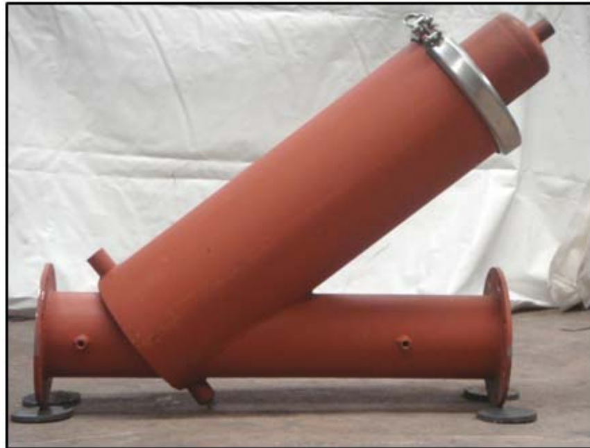
Figura 36. Filtro de mallas modificado terminado.
