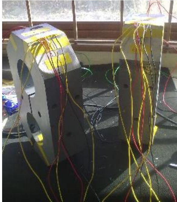
Figura (4.2) Galgas montadas y cableadas en el sensor octagonal extendido con capacidad de 40 kN.
