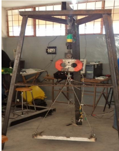
Figura (4.3) aparato empleado para la calibración en forma individual de los Octagonales de anillo extendido (OAE).
