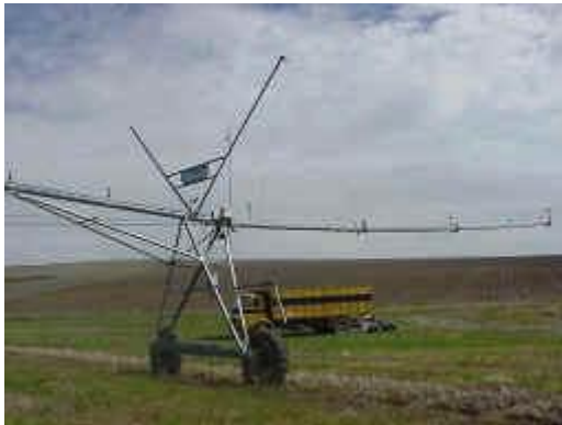
Figura 2.4 Tubería porta rociadoras
