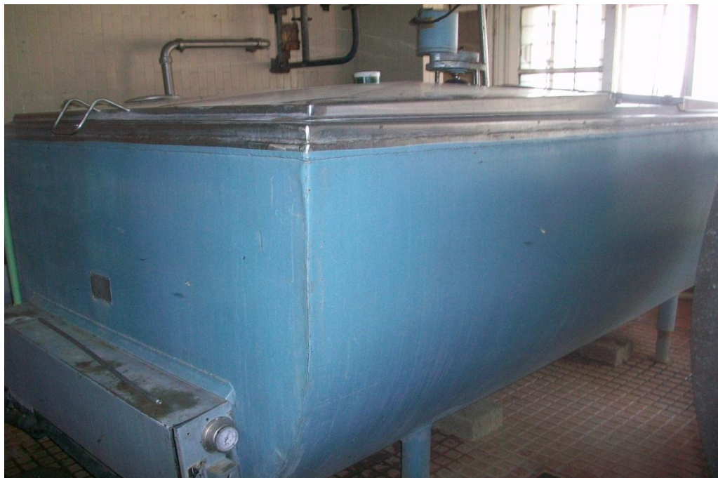
Imagen 3. Tanque de enfriamiento del establo lechero de la UAAAN.
