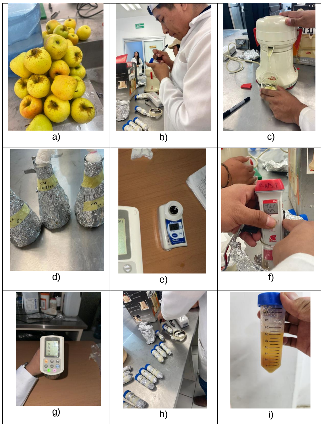
Figura 4. Proceso de supervisión y preparación del jugo de manzana para la vida de anaquel. a) Obtención y limpieza de materia prima, b) Identificación de tubos cónicos, c) Extracción de jugo de manzana, d) Dosificación de las diferentes cantidades de ácido kójico al 0.5%(0 a 25 mL), e) Medición de °Brix, f) Determinación de pH, g) Determinación de colorimetría, h) Refrigeración, i) Identificación de efecto del ácido kójico al 0.5%.
