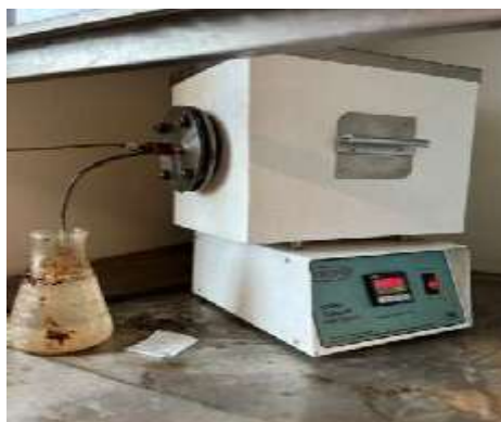
Fig. 11 Horno tubular horizontal con reactor de cuarzo Vichi HT-100.
