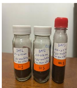
Figura 10: La biomasa de cáscara de nuez como soporte y matriz orgánica para la síntesis de nanocompuestos de magnetita-biocarbón (BMF). Se destaca su porosidad y capacidad de interacción para la estabilización de nanopartículas.
