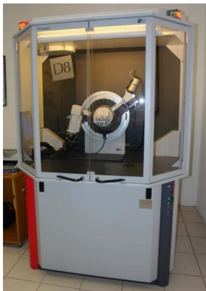
Figura 19 Difractómetro de rayos X marca Bruker utilizado para el análisis estructural de los materiales sintetizados.
