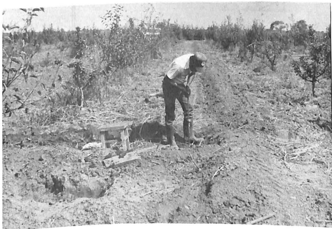
Figura 7. Determinación de la resistencia del suelo a la penetración con penetrámetro de impacto.
