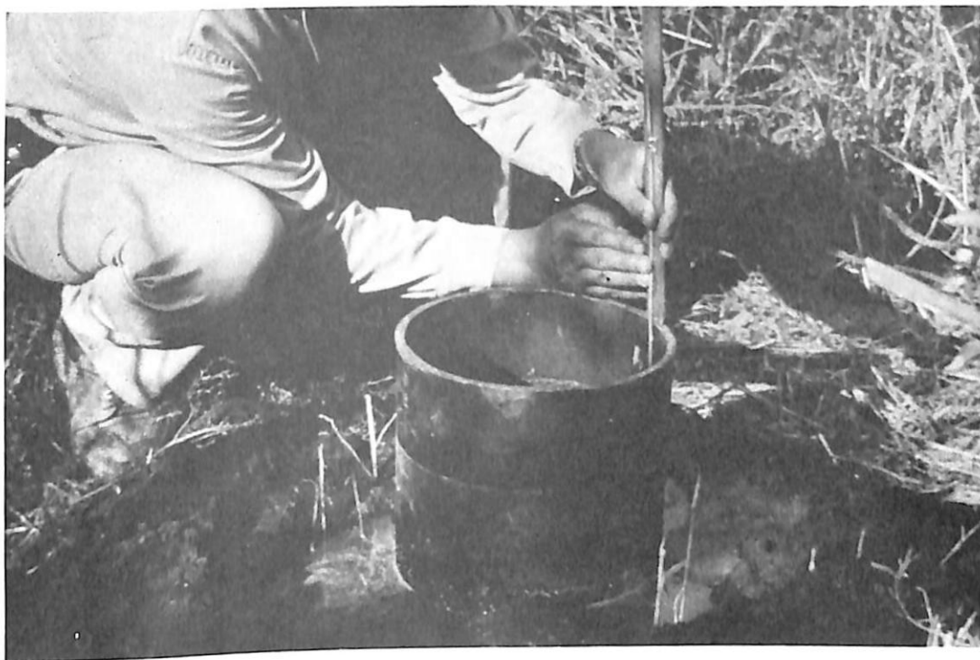
Figura 6. Toma de lecturas para determinar la velocidad de infiltración del suelo.
