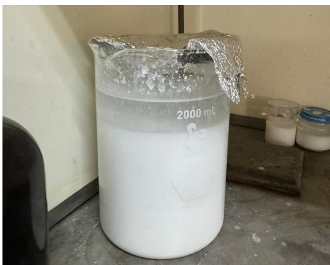
Figura 2: Proceso de precipitación química húmeda
