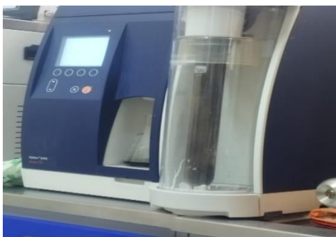
Figura 9: Equipo KJELTEC TM 8100
