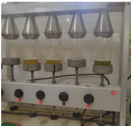
Figura 8: Digestor de fibra labconco
