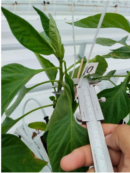
Imagen 13. Vernier medición de tallo.
