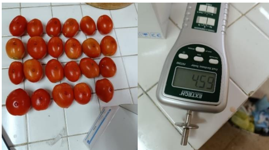
Figura 5. Medición de firmeza de fruto de tomate, con penetrometro portátil
