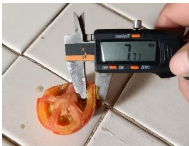
Figura 7. Medición de mesocarpio de fruto de tomate con un vernier digital
