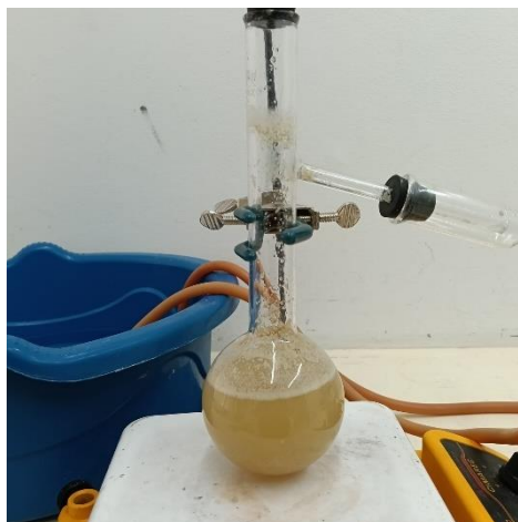
Figura 44 Líquido filtrado calentándose sobre placa eléctrica
