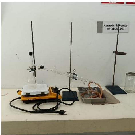
Figura 43 Se monto el material para destilar
