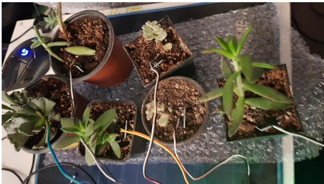
*Ilustración 3 Implemento de los higrómetros en 6 plantas diferentes para su análisis.*
