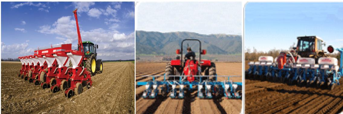
**Figura 4.** Sembradora de precisión, o monograno.
